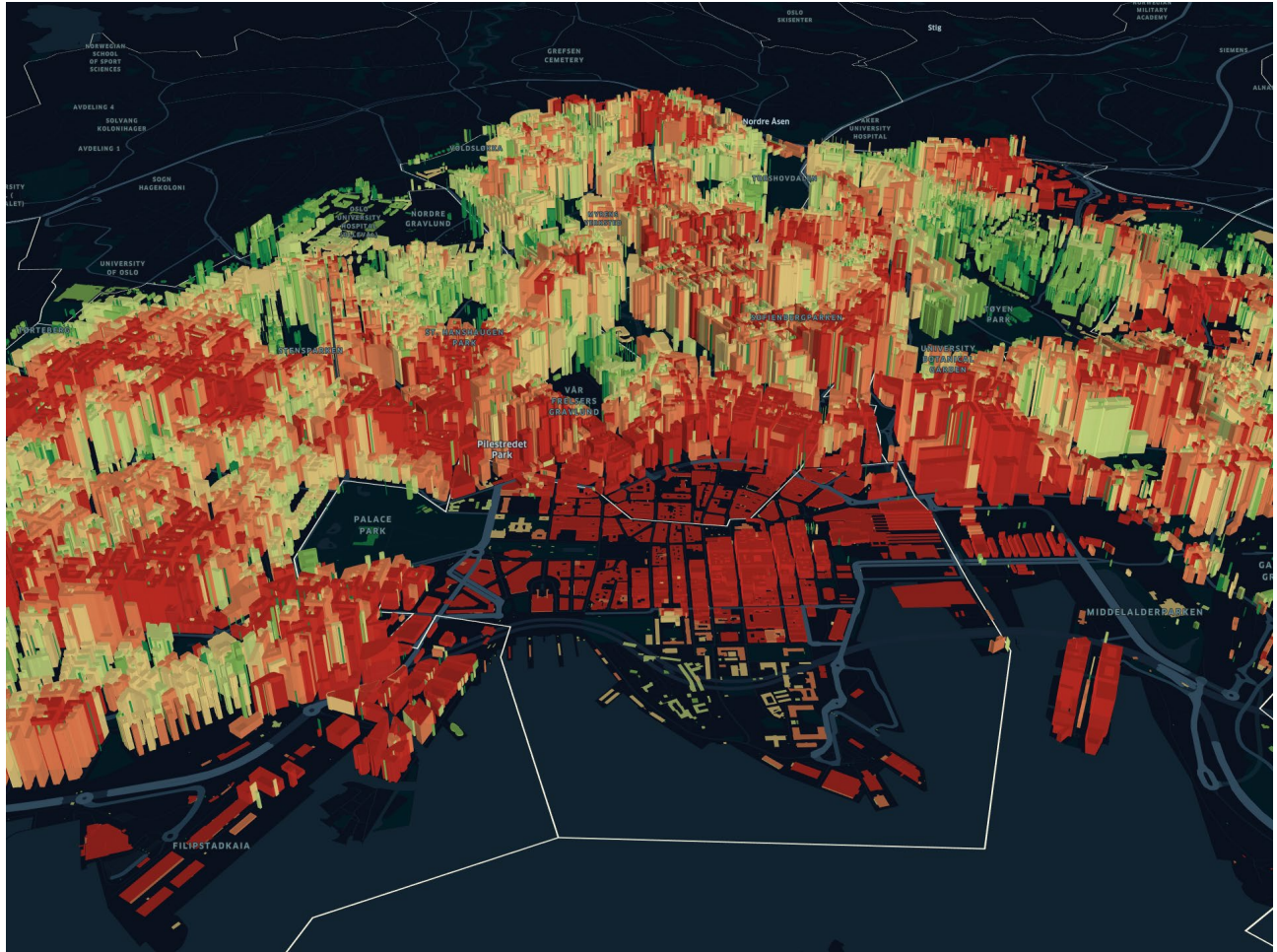
Figur 2 Fasade-arealer kan grovmodelleres gjennom 3D kartlegging, vektes i forhold til eksponeringsgrad fra gateplan og sammenlignes med mangelområder for økosystemtjenester
